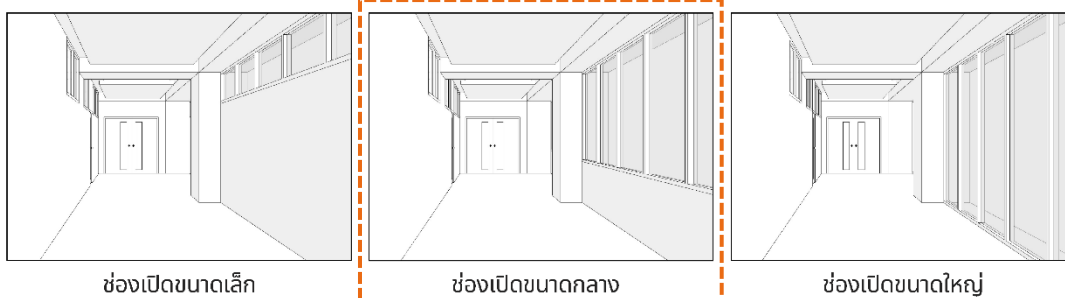
ภาพที่ 6. 18 ขนาดช่องเปิดโถงทางเดิน
